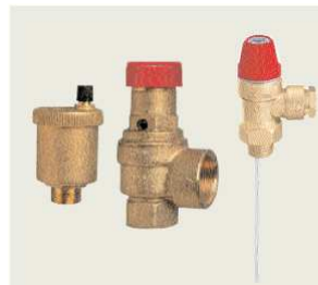
Kit valvole (421600) composto da: valvola automatica sfogo aria, sicurezza 1,5 bar, scarico termico 90°C
